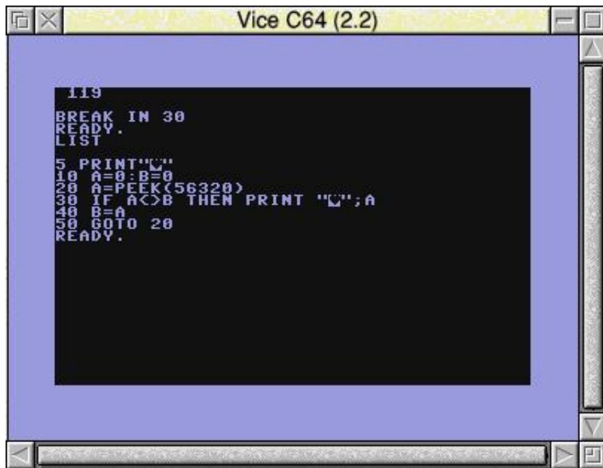
Bild 2.2: Abfragen des Joysticksports 2 am Commodore 64 im BASIC. Die Zahl auf dem Bildschirm ändert sich, wenn man den Joystick bedient. Es ist der Wert, welcher vom Baustein CIA an die Speicheradresse 56320 geschrieben wird.
